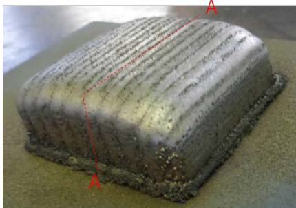
Fig.5 LC施工の造形物 (50×50×15 mm)
