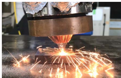
Fig.15 スパッタの多い粉末の LC 施工
