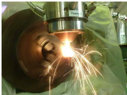
Fig.1 シャフト外周のレーザクラディング
