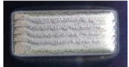
Fig.4 予熱有り無し LC 施工後外観
