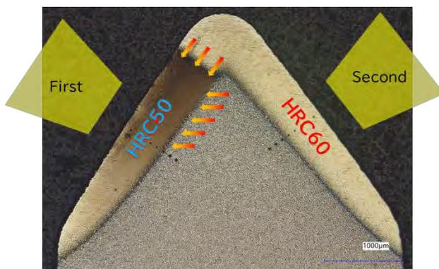
Fig.13 2面焼入れによる硬度低下
