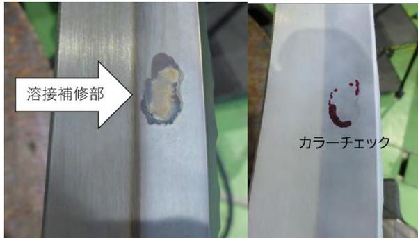
Fig.12 溶接補修部へのレーザ焼入れ
