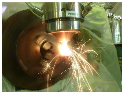
Fig.1 シャフト外周のレーザクラッディング
