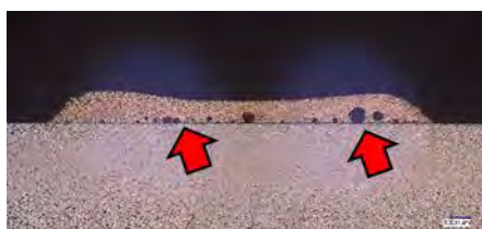
Fig.6 LC による内部欠陥(ブローホール)
