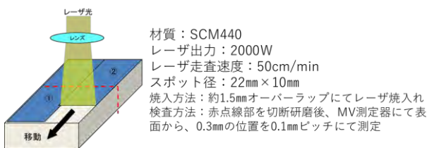
Fig.9 広い面積のレーザー焼入れ実験模式図
