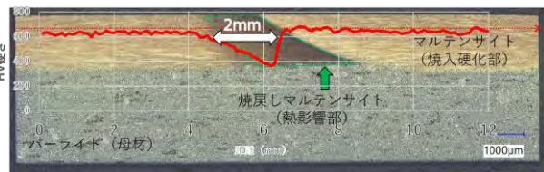
Fig.10 ソフトゾーン硬度測定、組織写真
